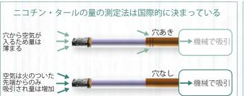
上図に記載しました通り、フィルター側面の穴から空気が入るため、ニコチン量が見かけ上低く測定されてしまうのです。
